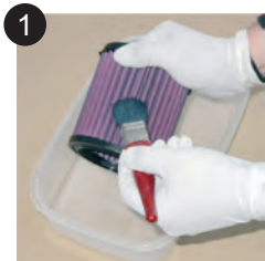
1 Größten Schmutz trocken abbürsten
