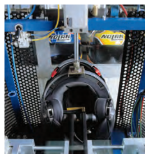
Stabilitätstest der Außenhülle
