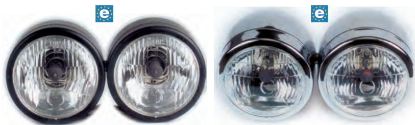
Doppel-Motorradscheinwerfer, seitlich jeweils mit Gewinde zur Befestigung, Breite 218mm, Tiefe 60mm. „e“-Prüfzeichen, kpl. mit H4 Lampen, gewölbte Gläser, Fern-, Abblend- und Standlicht
