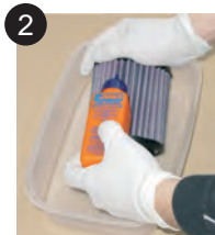
2 Filter mit Reiniger tränken und ca. 10 Minuten einwirken lassen
