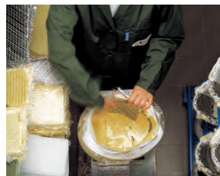
Handarbeit bei der Helmschale
