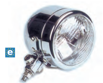
Motorradscheinwerfer mit Schwenksoc­kel, „e“-Prüfzeichen, kpl. mit H4 Lampe, gewöl­btes Glas, Tiefe 100mm, Fern-, Abblend- und Standlicht
