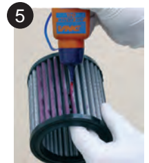
5 Reinigungsöl an den Filterfalten auftragen und einwirken lassen, bis der Filter eine gleichmäßige hellrote Tönung aufweist
