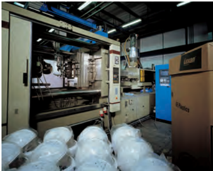
Einspritzen des Polycarbonats in die Helmschale
