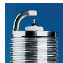
Die neue Mittelelektrode mit der nur 0,6 mm starken Iridiumspitze
