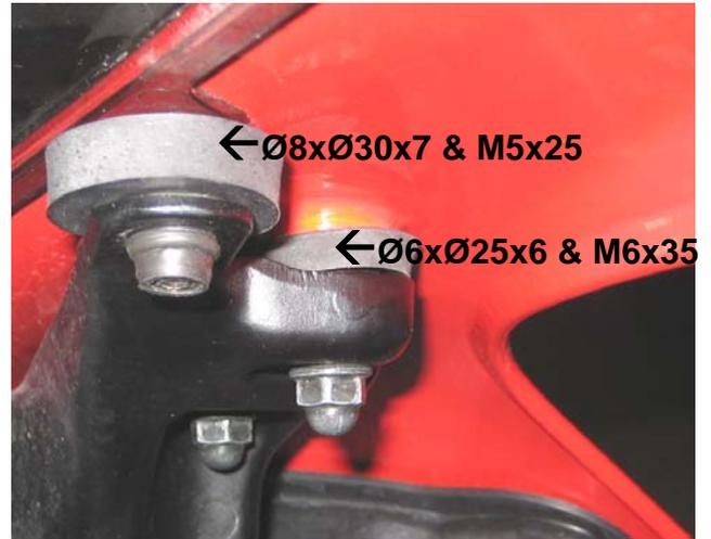
**Verkleidung anheben:** Die hintere Spiegelverschraubung mit der Gummischeibe Ø6xØ25x6 unterlegen und die original Spiegelschraube gegen die beiliegende M6x35 tauschen. Die Verkleidung am Halter mit der Gummischeibe Ø8xØ30x7 unterlegen und die Schraube M5x25 verwenden.
