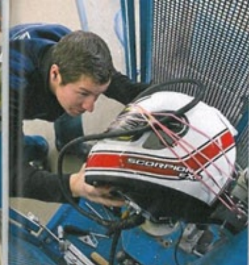
Jerome Lenßen fixiert den Scorpion mit Gummibändern, damit er während des Falles nicht verrutscht
