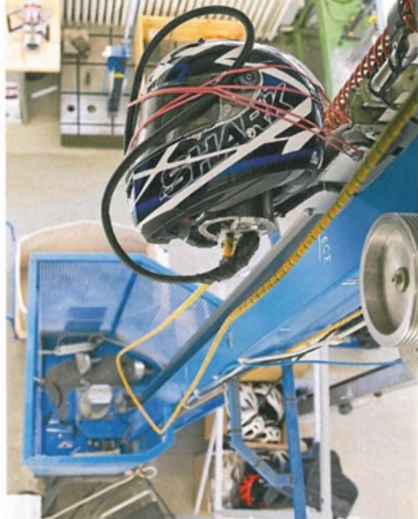
Jerome Lenßen fixiert den Scorpion mit Gummibändern, damit er während des Falles nicht verrutscht
