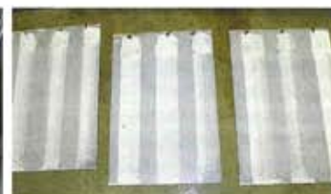
Immer schön der Reihe nach: In der Wischtestmaschine traten jeweils drei Testteilnehmer gegeneinander an (links). Heraus kamen mehr oder weniger saubere Spuren auf den verunreinigten Blechen (oben)
