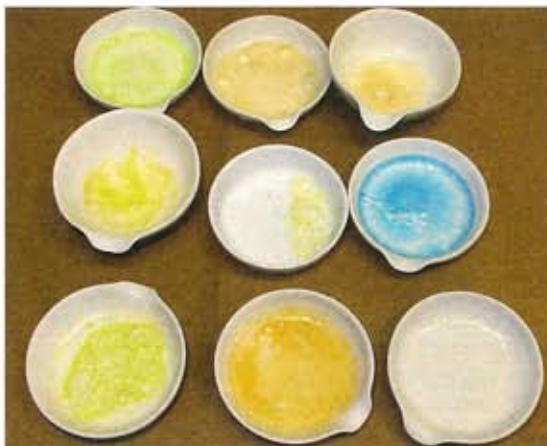
Der Rest vom Test: Das da links bleibt übrig, wenn man den Reiniger mithilfe des „Moisture Analyzers“ (oben) das Wasser entzieht
