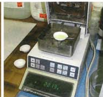
Der Rest vom Test: Das da links bleibt übrig, wenn man den Reiniger mithilfe des „Moisture Analyzers“ (oben) das Wasser entzieht
