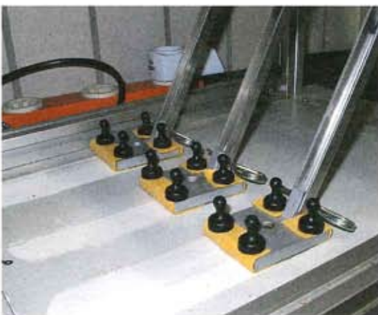
Immer schön der Reihe nach: In der Wischtestmaschine traten jeweils drei Testteilnehmer gegeneinander an (links). Heraus kamen mehr oder weniger saubere Spuren auf den verunreinigten Blechen (oben)
