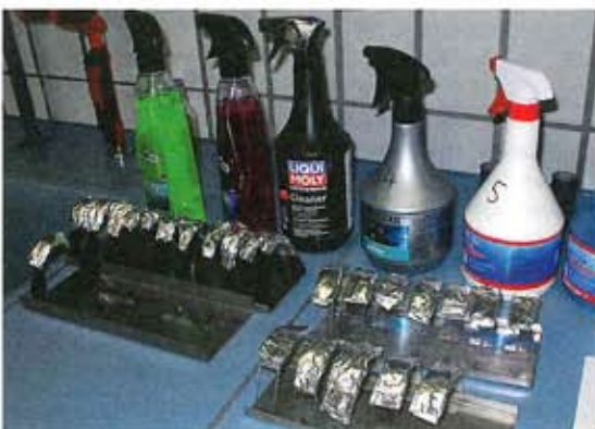
Und es hat knack gemacht: Materialverträglichkeits-Test vorher (links) und nachher (oben). Die schwarzen ABS-Streifen blieben heil, einige der transparenten Polycarbonat-Streifen gingen in die Brüche
