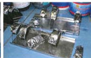
Und es hat knack gemacht: Materialverträglichkeits-Test vorher (links) und nachher (oben). Die schwarzen ABS-Streifen blieben heil, einige der transparenten Polycarbonat-Streifen gingen in die Brüche
